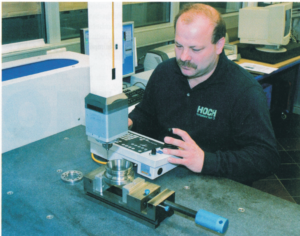
Messen von Drehteilen bei der Denzlinger Karl Hoch GmbH an einem Koordinatenmessgerät Contura G2 aktiv.
